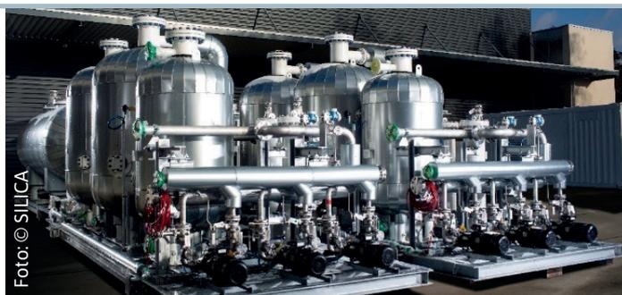
SILICA Verfahrenstechnik GmbH – H<sub>2</sub> Trocknungsanlage vor Auslieferung
