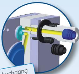
Fluiddurchgang mit hermetischer Ventildichtung
