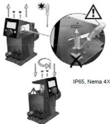
Abb. 7 Bedienkubus ausrichten
