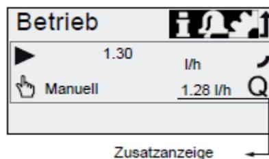
Abb. 34 Display mit Zusatzanzeige
