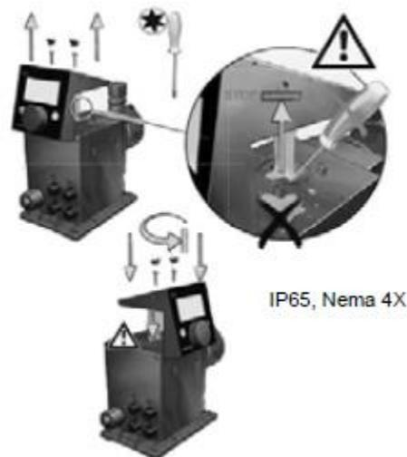
Abb. 7 Bedienkubus ausrichten
