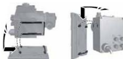
Abb. 6 Einrasten der Pumpe
